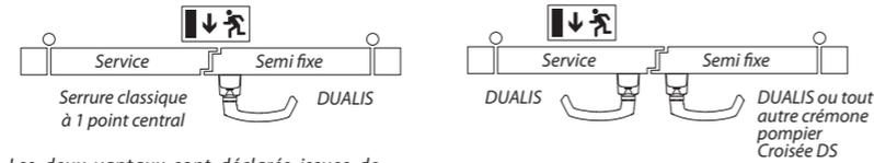
Les deux vantaux sont déclarés issues de secours sous réserve que la manoeuvre de la fermeture d'urgence entraîne l'ouverture du vantail de service et du vantail semi-fixe.
