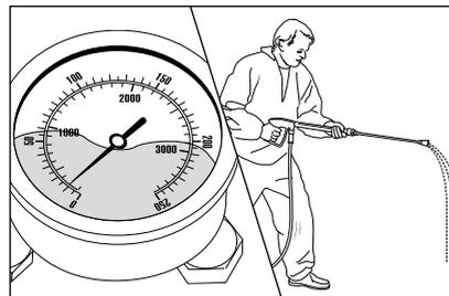
Bien que le régulateur de pression soit entièrement ouvert, le manomètre avec boîtier inox est très faible et un jet d'eau irrégulier sort de la lance. Le flexible haute pression vibre.
