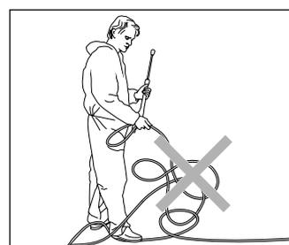
Ne pas tendre le flexible haute pression s'il y a formation de boucles ! Ne pas tirer ou laisser frotter le flexible haute pression sur une arête vive !
