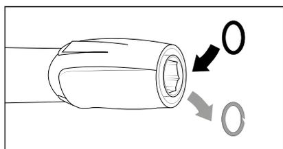
Arrêter l'appareil. Ouvrir brièvement le pistolet marche/arrêt de sécurité pour dépressuriser le système. Débrancher le flexible HP, le pistolet et la lance, puis contrôler l'état des joints d'étanchéité. Remplacer immédiatement les joints toriques s'ils sont défectueux.
