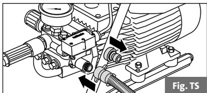
1. Brancher le tuyau d'aspiration avec filtre d'aspiration (N° de réf. 150383).
