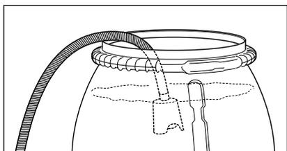
2. Accrocher le tuyau rempli d'eau au fût rempli d'eau et commencer les travaux de nettoyage.
