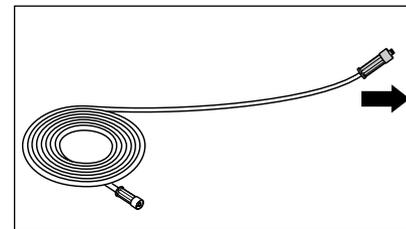
2. Dérouler le flexible haute pression en le tirant dans le sens perpendiculaire à l'axe de l'enrouleur et en veillant à ne pas faire de boucle. Le flexible HP peut laisser des traces de frottement sur certains sols. En alternative, vous trouverez aussi des flexibles HP Non-Marking dans notre gamme de produits.
