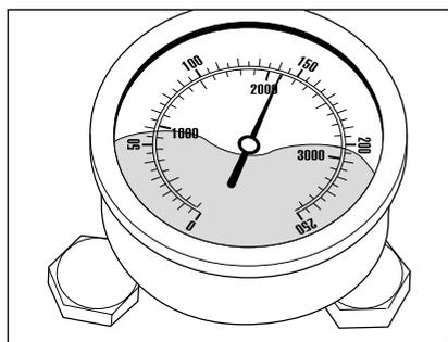
Après la fermeture du pistolet Marche/Arrêt de sécurité, le régulateur de pression-clapet de sûreté doit commuter et le manomètre avec boîtier inox doit alors indiquer „0“ bar. Si la commutation n'a pas lieu et que le manomètre avec boîtier inox continue à indiquer pleine pression, la cause peut être une fuite au niveau de la pompe haute pression, du pressostat, du flexible haute pression ou du pistolet Marche/Arrêt de sécurité.
