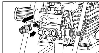
Enlever le barillet anti-retour et s'assurer que le joint torique n'est ni sale, ni endommagé. Contrôler également le siège d'étanchéité dans le carter de pompe haute pression et s'assurer qu'il n'est ni sale, ni endommagé.
