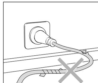
N'utiliser un cordon d'alimentation électrique que si celui-ci est en parfait état ! Ne pas endommager cordon d'alimentation électrique (le tirer violemment, l'écraser, passer dessus avec un véhicule) ou le réparer de manière inadéquate !
