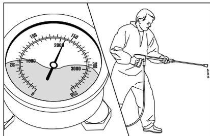
Le manomètre avec boîtier inox indique pleine pression. Cependant, l'eau ne sort pas ou ne sort que goutte à goutte de la lance.
