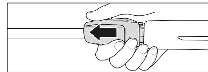
6. Après insertion de la lance dans le raccord, relâcher la douille et vérifier si la lance est bien enclenchée. **Graisser régulièrement le raccord baïonnette avec une graisse sans acide.**
