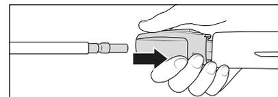
5. Tirer tout d'abord vers l'arrière la douille d'enclenchement du pistolet avant d'insérer la lance dans le raccord rapide.
