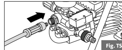
3. Raccorder à la sortie de pompe le flexible haute pression compris dans la livraison (raccord vissé rotatif - gris) fermement et de manière étanche à la pression.
