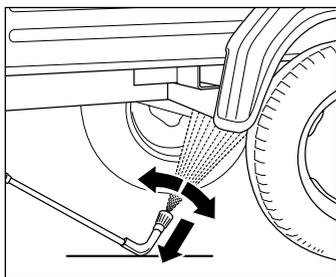
Lors de l'utilisation de la lance bas de caisse, celle-ci doit absolument en contact avec le sol avant l'ouverture du pistolet ! Pour les lances cintrées ou recourbées, le coup de bélier produit un couple de rotation très sensible. (La lance bas de caisse et un accessoire disponible en option.)
