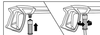
4. Brancher le raccord gris pivotant du flexible HP sur le pistolet Marche/Arrêt de sécurité, puis les visser fermement entre eux pour établir un raccordement étanche à la pression.
