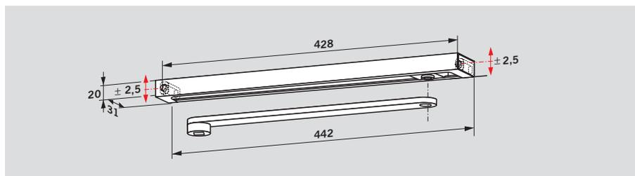
La glissière **DORMA G-N** comprend: bras, glissière, coulisseau, support de fixation et embouts. Elle est réversible droite/gauche et s'adapte aux TS 93 B 2S/G 2S et TS 93 B/G.
