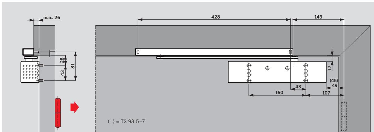
TS 93 G DORMA – montage sur vantail (montage normal) côté opposé aux paumelles. Si l'environnement de la porte le permet, ce type de montage autorise un angle d'ouverture entre 120° et 140° environ. Pour protéger le mur et la porte de tout endommagement, il est
