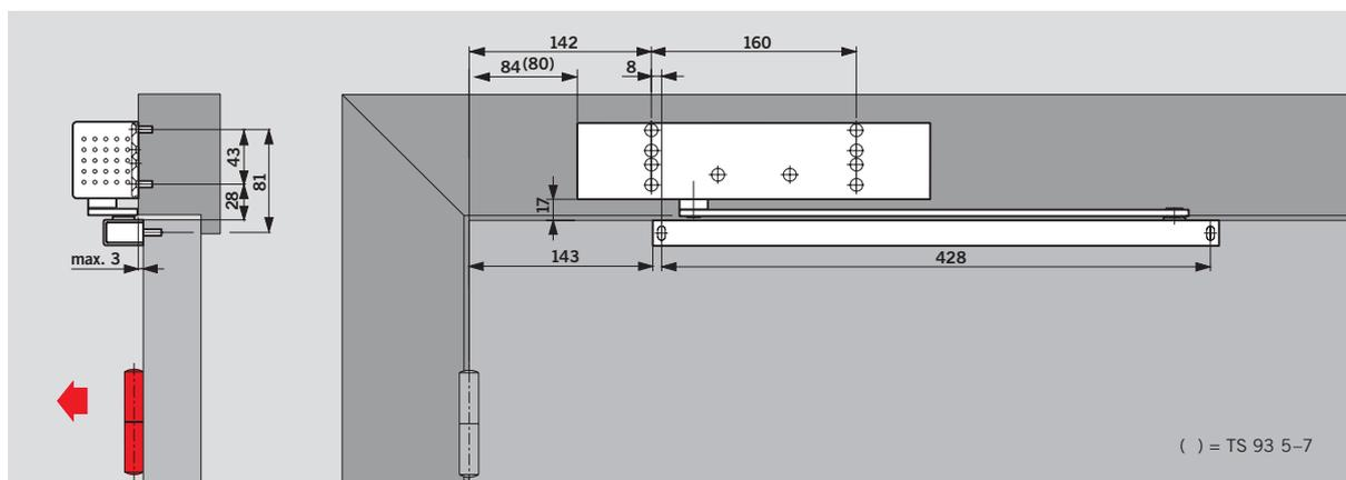
TS 93 G DORMA – montage sur dormant (montage renversé) côté paumelles. Si l'environnement de la porte le permet, ce type de
