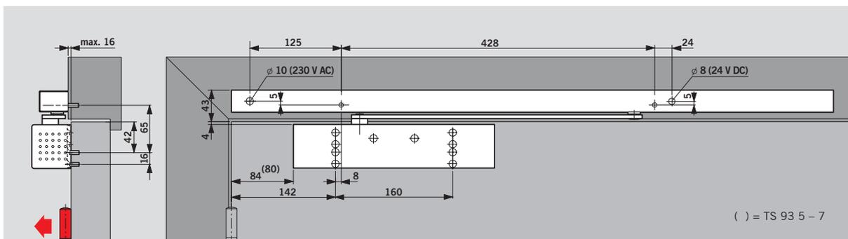
Ferme-portes DORMA **TS 93 B 2S/TS 93 B** avec glissière DORMA G-EMR. Montage côté paumelles.
