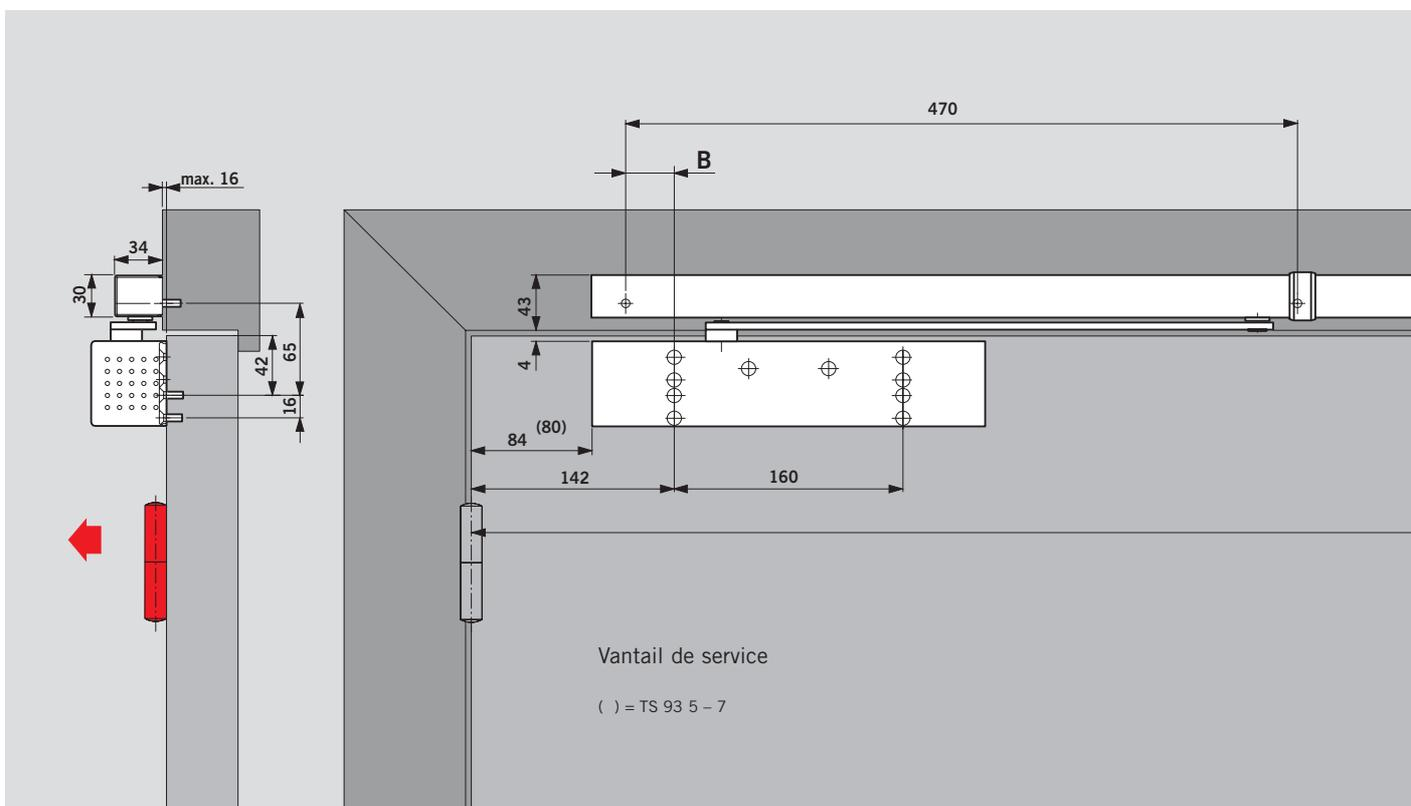
Régulateur de fermeture avec détecteur de fumée intégré (G-SR-EMR)
