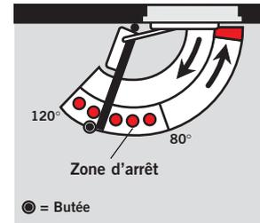
La glissière **DORMA G-EMF** détermine un point d'arrêt précis, sans recul de la porte. Le point d'arrêt est réglable entre 80° et 120°.
