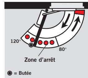
La glissière **DORMA G-EMR** détermine un point d'arrêt précis, sans recul de la porte. Cette glissière permet d'équiper des portes coupe-feu de façon totalement autonome. Le point d'arrêt est réglable entre 80° et 120°.
