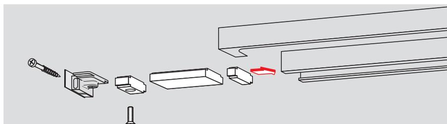
Accessoire pour glissières DORMA G-N, RF: **Limiteur d'ouverture** avec amortisseur progressif, pour intégration ultérieure dans la glissière. Réglable de 80° à 120° maximum.
