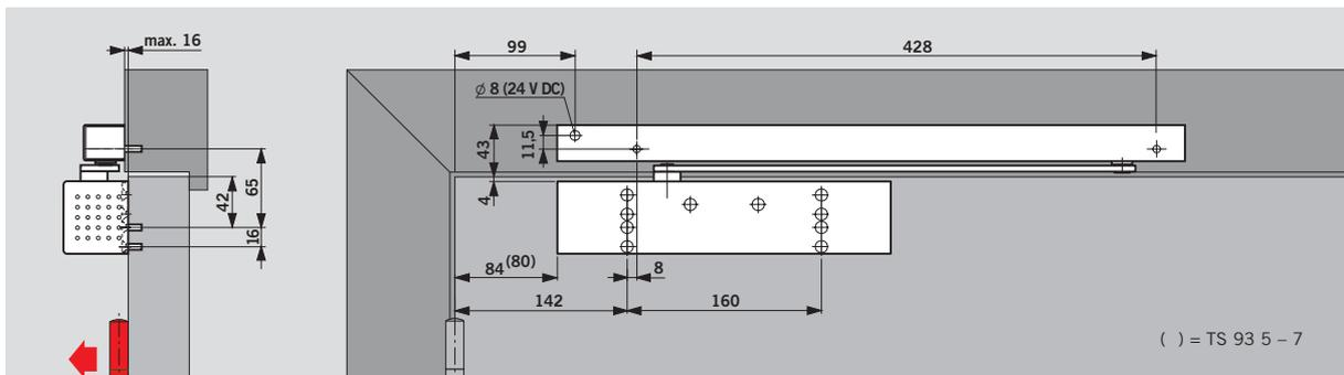
Ferme-portes DORMA **TS 93 B 2S/TS 93 B** avec glissière DORMA G-EMF. Montage côté paumelles.
