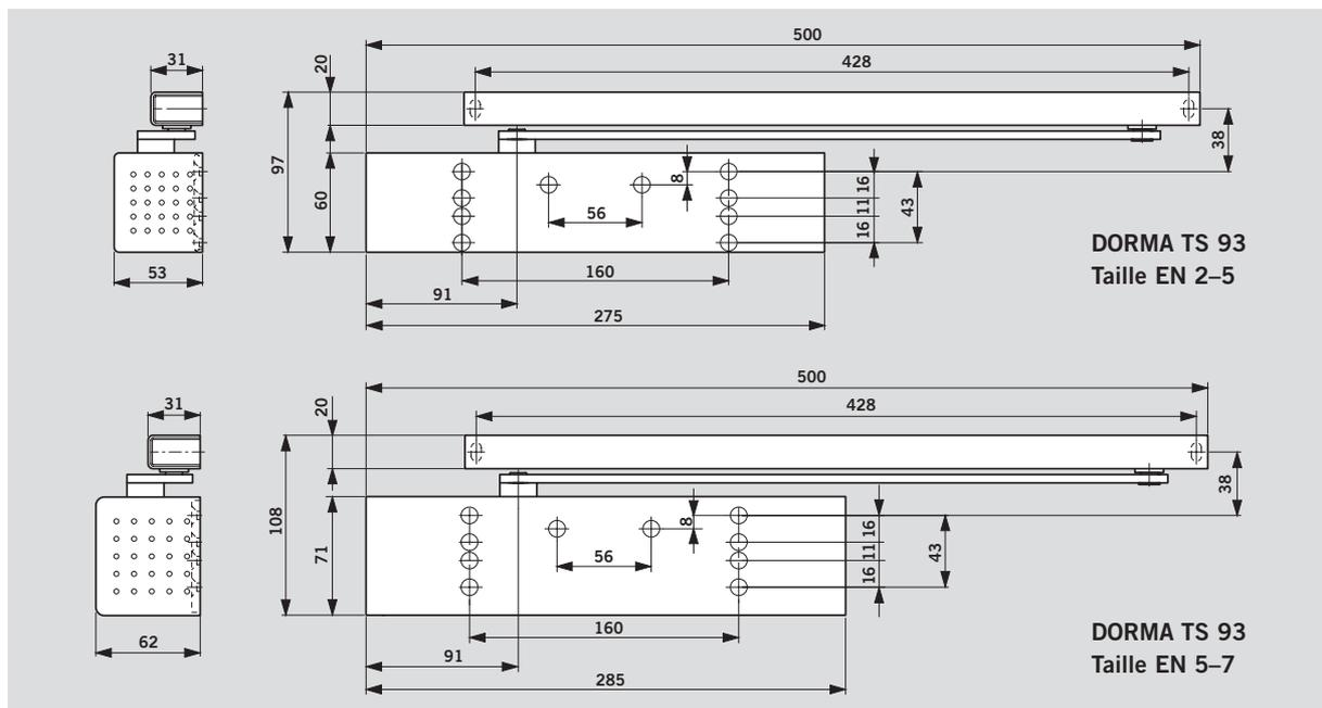
**Plaque de montage en série avec système de perçage universel.**
