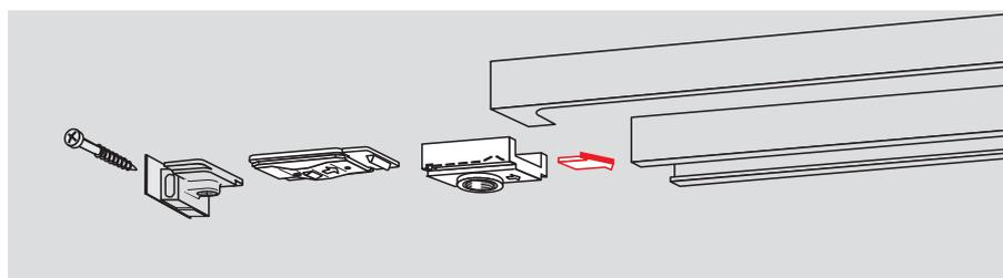
Le dispositif d'arrêt **DORMA RF** détermine un point d'arrêt précis sans recul de la porte. Le point d'arrêt est réglable entre 75° et 150° environ. Il est facilement débrayable par l'utilisateur, et la force de maintien peut être adaptée à chaque type de porte.
