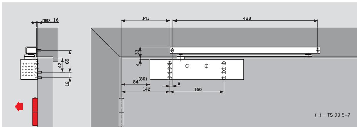
TS 93 DORMA – montage sur vantail (montage normal) côté paumelles.
