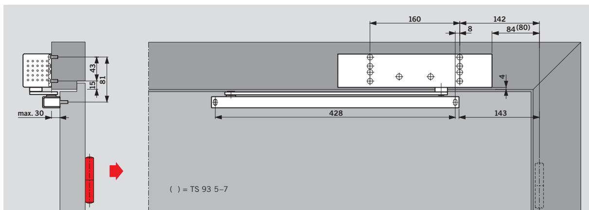
TS 93 B DORMA – montage sur dormant (montage renversé) côté opposé aux paumelles. Avec ce type de montage, le freinage à l'ouverture et le retardement à la fermeture sont sans effet. Si l'environnement de la porte le permet, ce type de montage autorise un angle d'ouverture entre 120° et 145° environ.
