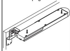
**Ferrure pour vantaux coulissant à l'intérieur du corps de l'armoire, jusqu'à 40 kg par vantail.**
