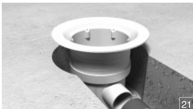
Mise en place du siphon. Pour les versions SITAR et SITARAL, coller le bouchon dans la sortie non utilisée.
