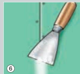
6 Réalisation des joints avec un enduit de lissage.
