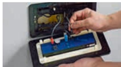
3 L'alimentation en tension est reliée à la commande à l'arrière de la plaque de commande. Les câbles sont insérés dans le guidage. Alternativement, il est également possible d'utiliser un logement de piles.
