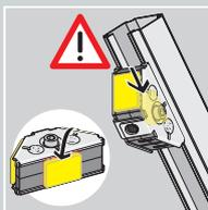
En cas d'utilisation du côté long du galet, un élément de blocage est requis pour le côté court.
