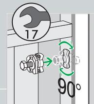
Poser les rails verticaux avec les modules à une distance de 430 mm. En cas de rails sans modules, la distance ne doit pas dépasser 500 mm. Insérer ensuite les coulisseaux dans le profilé et les pivoter à 90°. Serrer ensuite à l'aide d'une clé polygonale de 17.
