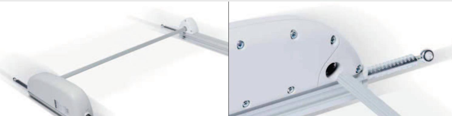
**...simple...** actionneur linéaire à crémaillère avec force de poussée et de traction de 450N. La structure portante est en matériel composite à résistance élevée, avec crémaillère en acier à section ronde. Grâce à un système à étai coulissant, on peut fixer l'actionneur sur toute la longueur de la tige, même en tête et le support est oscillant pour épouser la rotation de la fenêtre. SKY 450 peut être appliqué en tandem à une tige pour un deuxième point de poussée.
