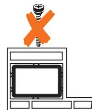
Les profils à préchambres peuvent se déformer lors d'un vissage direct.
