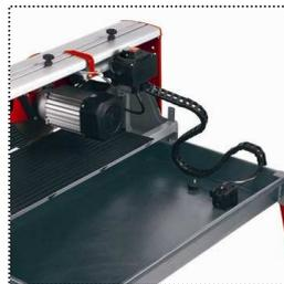
Bac de récupération de l'eau avec pompe intégrée pour liquide de refroidissement et bouchon de vidange
