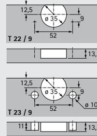
Schéma de perçage 45 x 9,5 mm
