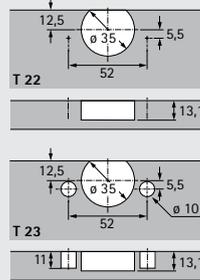
Schéma de perçage 52 x 9 mm
