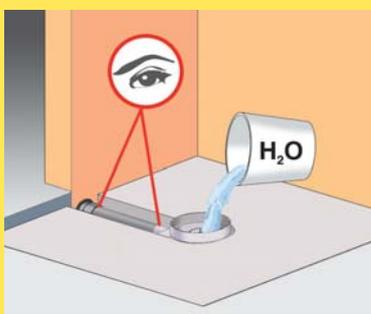
**A5** Raccorder la bonde à la canalisation d'évacuation principale à l'aide d'un tube PVC à coller. Vérifier l'étanchéité du raccordement en versant de l'eau dans la bonde.
