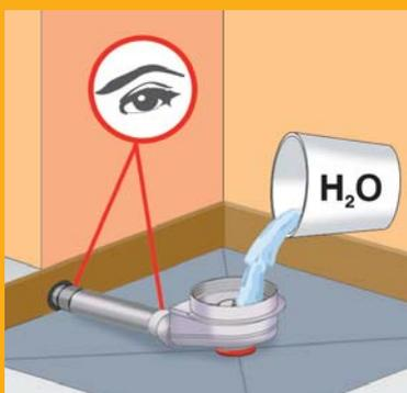
**B3** Raccorder la bonde à la canalisation d'évacuation principale à l'aide d'un tube PVC à coller. Vérifier l'étanchéité du raccordement en versant de l'eau dans la bonde.
