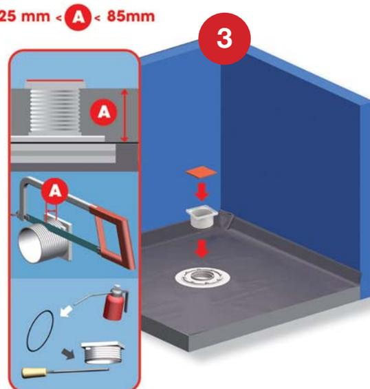
En fonction de la hauteur A de chape à réaliser, couper si besoin le support au ras d'un anneau afin que A soit comprise entre 25 et 85mm. Après la coupe, qui sera bien ébavurée, remonter le joint torique sur la dernière gorge du support. Mettre le support en position dans le corps de bonde, placer, le capot cache débris sur l'ensemble.
