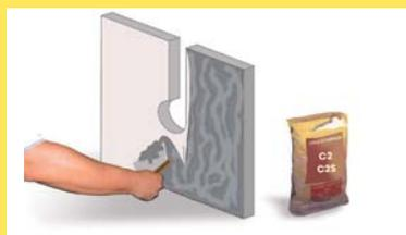
**A2** Encoller la face inférieure du support PSE à l'aide d'une colle de Type C2 ou C2S. (ne pas se tromper de face)
