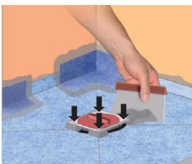
**M** Régler la hauteur définitive du support pour que le dessus soit au niveau du carrelage fini. Réaliser un renfort sous les angles du support.
